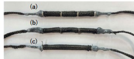
図2：固体ポリマーマッキベン人工筋肉
