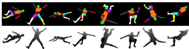
図1 臥位姿勢データセットの例。上段：身体部位ラベル画像，下段：距離画像
