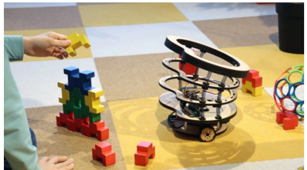
図2 共生型STEAM学習のためのロボット〈Toi〉
